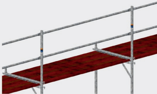
Bild 45: Oberer Abschluss mit Geländerpfosten und Belagsicherungen.
