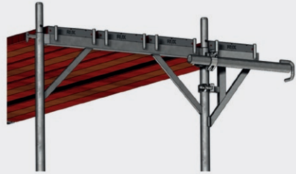
Bild 37: Kurzer Gerüsthalter, Ausführung mit Verbreiterungskonsolen innen
