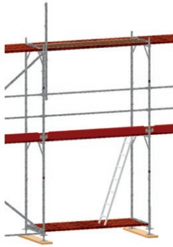
Bild 26: Montage des ersten MSG-Pfostens.
