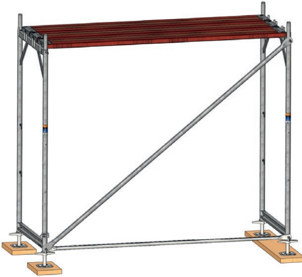
Bild 16: Fertig montiertes erstes Gerüstfeld
