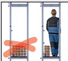
Bei Materiallagerungen ausreichend breiten Durchgang auf Belag freilassen
