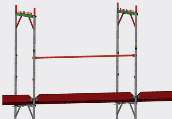
Bild 23: Empfohlene Anschlagpunkte am Vertikalrahmen
