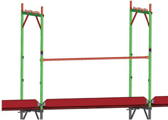
Bild 21: Zulässige Anschlagpunkte für die PSAgA am Vertikalrahmen.
