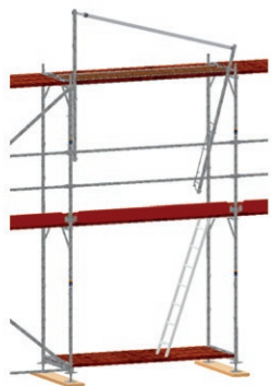
Bild 27: Einhängen des MSG-Geländers und zweiten MSG-Pfosten koppeln.
