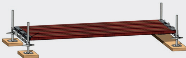
Bild 4: Systembeläge auf Belagtraversen
