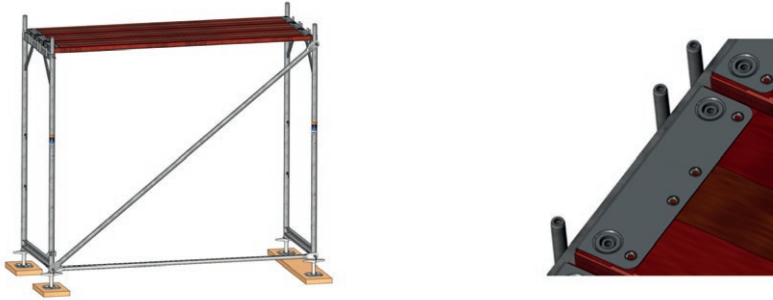
Bild 15: Systembeläge in die Zapfen eingehängt
