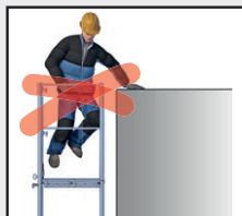
Auf Gerüstbeläge nicht abspringen
