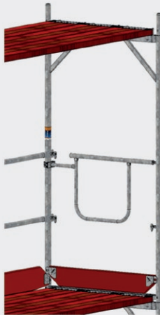
Bild 33: Stirngeländer montiert, offenes Rohrende auf einen Kippstift aufgesteckt.
