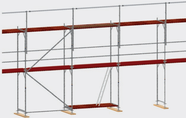
Bild 29: Montage der weiteren MSG-Einheiten
