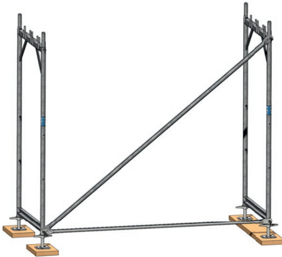
Bild 13: Aufbau des ersten Gerüstfeldes: Vertikaldiagonale
