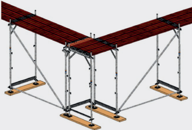
Bild 19: ECKAUSBILDUNG mit drei Vertikalrahmen
