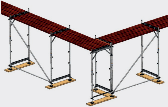
Bild 18: ECKAUSBILDUNG mit zwei Vertikalrahmen
