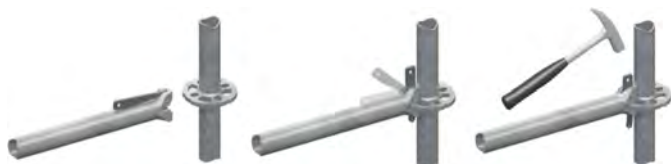
Bild 15 Verbindung an der Lochscheibe herstellen
