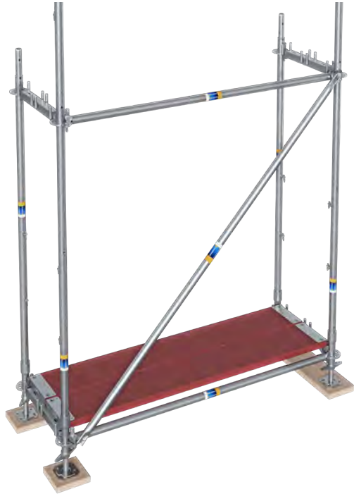
Bild 31 Vertikaldiagonale in der ersten Eben
