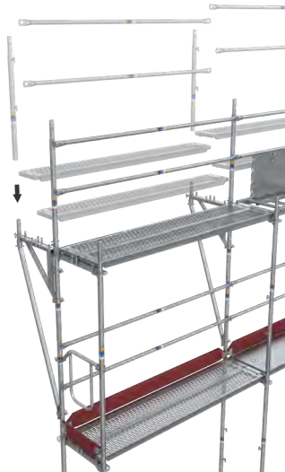
Bild 54 Obere Ebene: Belagbohle
