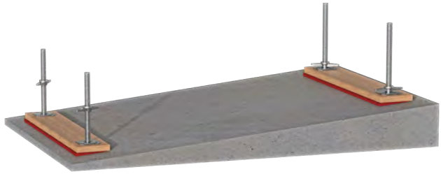
Bild 18 Unterbau auf geneigtem Untergrund
