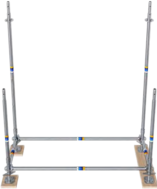
Bild 25 Aufbau mit Innenständer 2,00 m und Außenständer 1,00 m mit Kippstift mit RINGSCAFF-Anfangsstück
